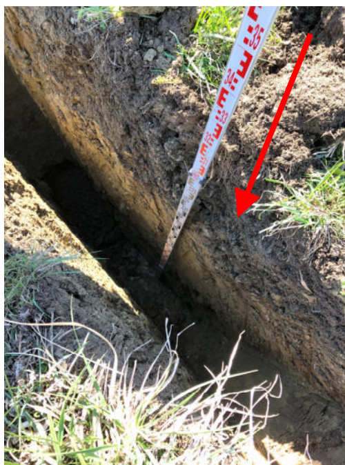
Foto 2: In-situ Lagerung „SCH3“ mit Markierung der beprobten Schicht.
